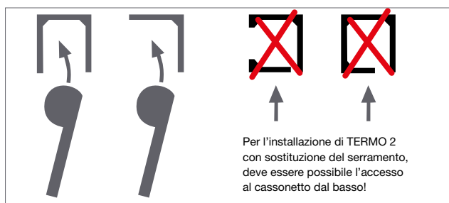
TERMO 2 con la sostituzione del serramento può essere installato solo in un cassonetto murato con revisione dal basso o dal basso+posteriore.
